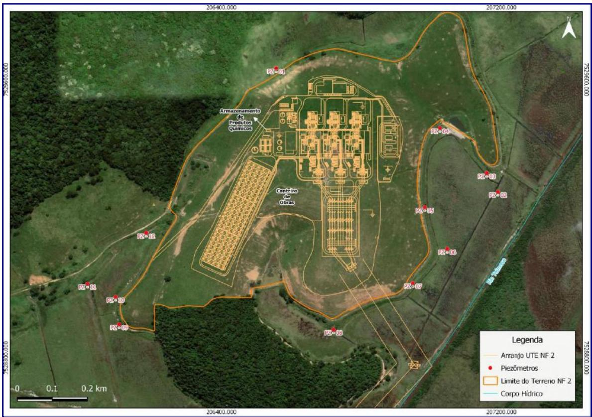
**FIGURA 3.5.2-10: LOCALIZAÇÃO DOS PIEZÔMETROS INSTALADOS NA ÁREA DA UTE**
